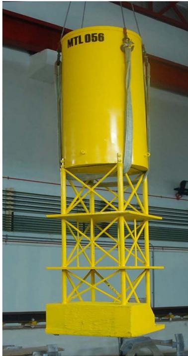
Fig. 1 Truss spar model (Scale: 1:73)
